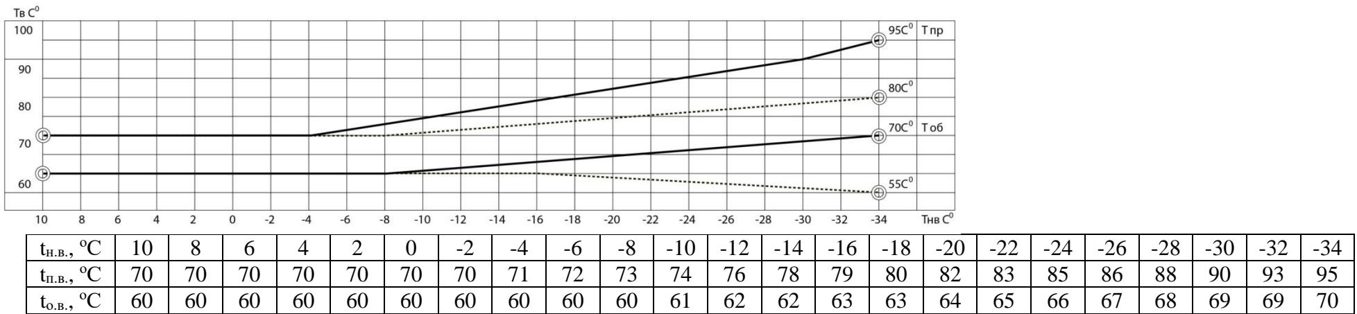
Рисунок 4. Температурный график и график ограничения отпуска тепловой энергии в случае принятия неотложных мер по предотвращению или ликвидации аварий в системе теплоснабжения для работы газовых котельных ООО «Никос-Сервис» на отопительный период 2021/22 год.
